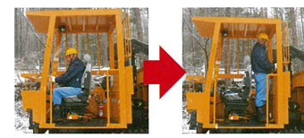
シート後方でのグラッブル操作 素早く作業に移行できる
